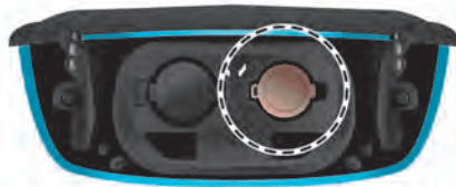
Θύρα κανονικής φόρτισης – Δεξιά πλευρά
