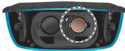
Θύρα κανονικής φόρτισης – Δεξιά πλευρά
