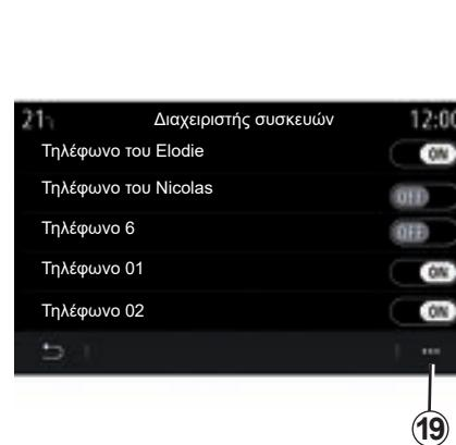
Χρησιμοποιώντας τη λειτουργία «Διαχειριστής συσκευών» 17, μπορείτε να επιλέξετε τα smartphone που θέλετε να συνδέσετε αυτόματα στο «Ενσωμάτωση Smartphone»
