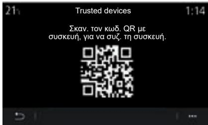
Μπορείτε να εγκρίνετε μια νέα συσκευή μέσω σάρωσης του συστήματος QR Code χρησιμοποιώντας το τηλέφωνό σας.
