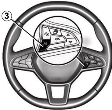
Μόλις ενεργοποιηθεί η εφαρμογή «Android Auto™» ή η υπηρεσία «CarPlay™», μπορείτε να χρησιμοποιήσετε το πλήκτρο φωνητικής αναγνώρισης στο αυτοκίνητό σας για να ενεργοποιήσετε ορισμένες φωνητικές λειτουργίες του smartphone σας. Για τον σκοπό αυτό, πιέστε το πλήκτρο **3** στο τιμόνι του αυτοκινήτου σας (για περισσότερες πληροφορίες, συμβουλευθείτε το κεφάλαιο «Χρήση φωνητικής αναγνώρισης»).
