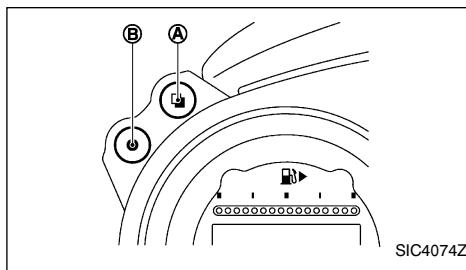
Οι διακόπτες για τον υπολογιστή ταξιδιού βρίσκονται στην αριστερή πλευρά του ταμπλό οργάνων. Για να χειριστείτε τον υπολογιστή ταξιδιού, πατήστε τους διακόπτες όπως φαίνεται πιο πάνω.
