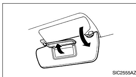
Για να έχετε πρόσβαση στους καθρέπτες των σκιαδίων, τραβήξτε κάτω το σκιάδιο και ανοίξτε το κάλυμμα του καθρέπτη.
