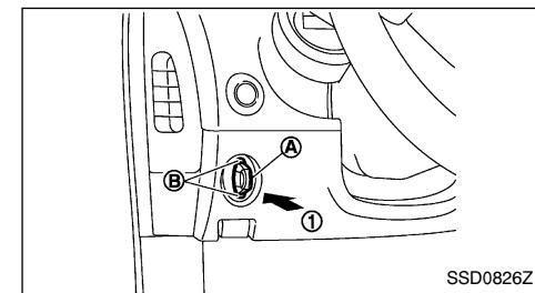
Εάν η μπαταρία του Έξυπνου Κλειδιού είναι σχεδόν άδεια, το φως οδηγός (B) στην θυρίδα Έξυπνου Κλειδιού (A) αναβοσβήνει και η ένδειξη εμφανίζεται στην οθόνη υγρών κρυστάλλων. (Δείτε το «Οθόνη υγρών κρυστάλλων» στο κεφάλαιο «2. Όργανα και χειριστήρια»).
