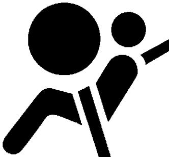
Το προειδοποιητικό φως του αερόσακου, ένδειξη "AIR BAG" ή στο ταμπλό των οργάνων, παρακολουθεί τα κυκλώματα του αερόσακου. Τα κυκλώματα που παρακολουθούνται από το προειδοποιητικό φως αερόσακου είναι η μονάδα αισθητήρα διάγνωσης, οι αερόσακοι και η σχετική καλωδίωση.
