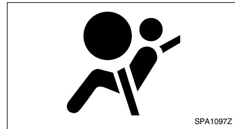
Το προειδοποιητικό φως του αερόσακου, που έχει την ένδειξη στο ταμπλό των οργάνων, ελέγχει όλους τους αερόσακους και τις ζώνες ασφαλείας με προεντατήρες καθώς και τα σχετικά κυκλώματα. Τα κυκλώματα που ελέγχονται από το προειδοποιητικό φως του αερόσακου είναι όλοι οι αισθητήρες, οι μονάδες των αερόσακων και οι σχετικές καλωδιώσεις καθώς και οι ζώνες ασφαλείας με προεντατήρα.
