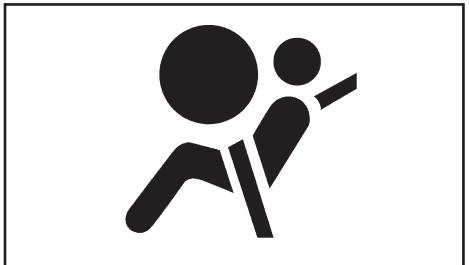
Το προειδοποιητικό φως του αερόσακου, που έχει την ένδειξη στο ταμπλό των οργάνων, ελέγχει όλους τους αερόσακούς και τις ζώνες ασφαλείας με προεντατήρες καθώς και τα σχετικά κυκλώματα. Τα κυκλώματα που ελέγχονται
