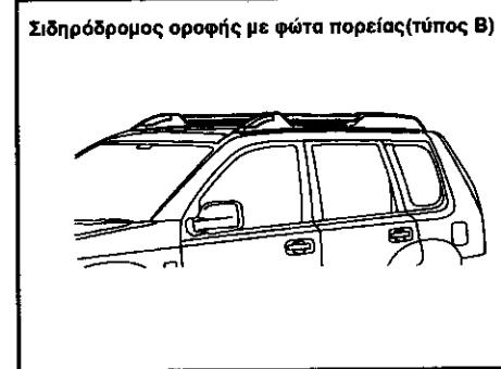
Μπορείτε να μεταφέρετε αποσκευές στην οροφή του αυτοκινήτου, χρησιμοποιώντας σχάρα στον σιδηρόδρομο οροφής. Για την τοποθέτηση και την χρήση της σχάρας, ακολουθείστε τις οδηγίες του κατασκευαστή της. Ο σιδηρόδρομος οροφής είναι σχεδιασμένος για να μεταφέρει φορτία (βάρος αποσκευών συν το βάρος της σχάρας) κάτω από 100 κιλά. Η υπερφόρτωση μπορεί να προκαλέσει ζημιά στο αυτοκίνητο.
